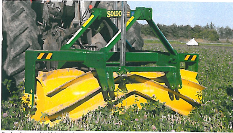
Knivtromlen – også kaldet roller crimper – som ikke skærer noget over, men lægger afgrøden ned samtidig med, at stænglerne får et knæk, så planten dør. Foto: Stig F. Nielsen.
