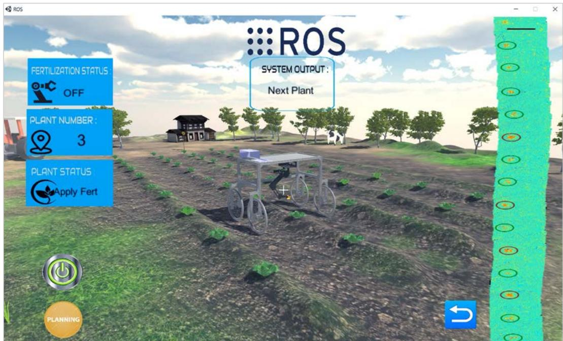
posición estimada de la plataforma para cada instancia. A medida que la plataforma robótica avanza del punto 1 al 7, el L-PC acumula valores anteriores, lo que mejora continuamente la estimación de la ubicación.
